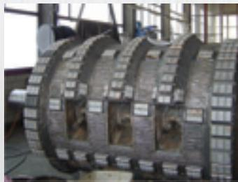
Internacionalni proizvođač opreme za rudarstvo, tunelogradnju i otvorene kopove DBT iz Njemačke na svoje drobilice izložene najtvrdim abrazivnim medijima ugrađuje DOMITE ploče čokoladnog oblika
