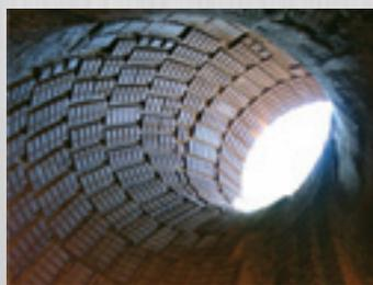
Jedna od najzahtjevnijih i najsirovijih industrija na svijetu – jaružanje ili dredging sustavno desetljećima koristi DOMITE zaštite od bijelog, lako zavarljivog ljeva tvrdoće 700HB. Na taj način, korozivni i abrazivni mediji
