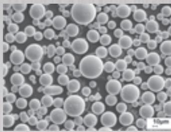
Unaprijeđenjem mikrostrukture postižu se vrhunske karakteristike. Zahvaljujući strogoj kontroli procesa proizvodnje, omogućene su uvijek jednako dobre karakteristike dodatnog materijala. Na slici je prikazan sferni volfram-karbid koji ima 30% veću tvrdoću i oko 50% bolju otpornost na trošenje u odnosu na standardni volfram-karbid.
