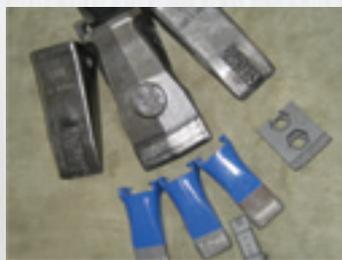
Tvrdo navareni noževi pokretne građevinsko-rudarske mehanizacije traju i do 10 puta dulje u odnosu na nezaštićene. DURUM dodatni materijali su jednostavni za korištenje. Nanešeni slojevi na bazi volfram-karbida, krom-karbida, niobija i drugih elemenata produljuju radni vijek mehanizacije i prateće opreme te značajno smanjuju troškove rada.
