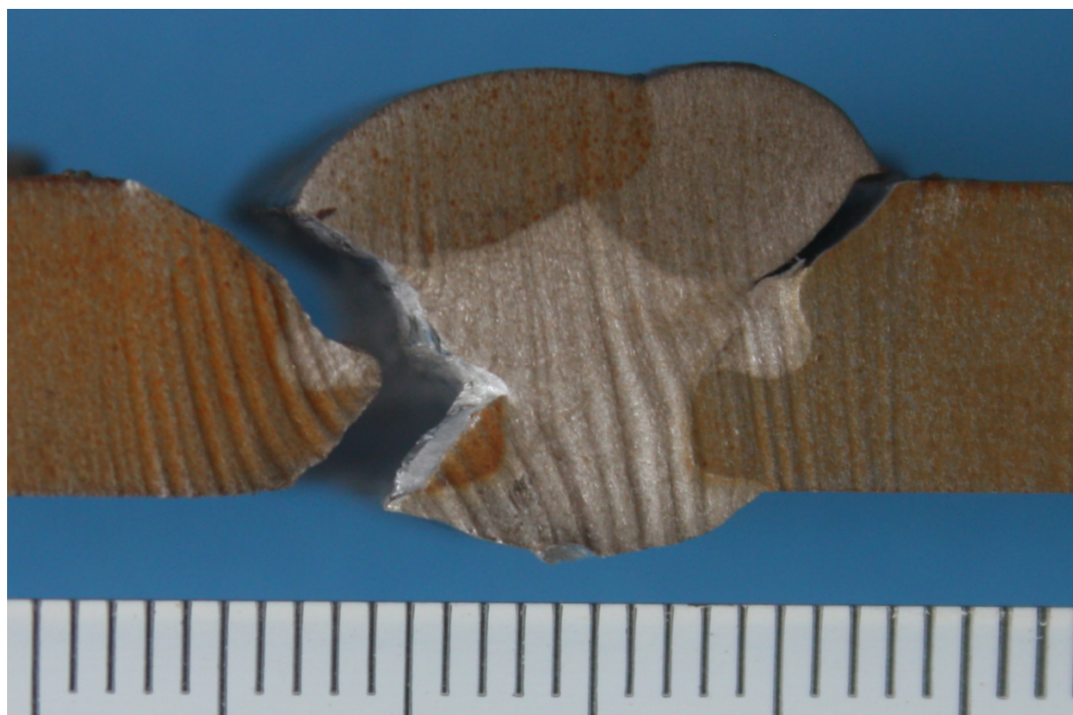
Slika 82. Uzorak K4-2, bočni pogled
