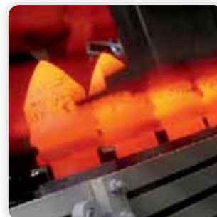
Postupak lemljenja kojim se trajno spajaju sinterirani tvrdi metal i žilavi čelik
