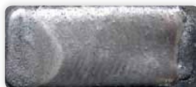
Izgled navarenog sloja
