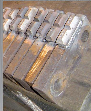
Specijalni čekići tvrdoča do 64 HRc osiguravaju vrhunsku trajnost pri radu s abrazivnim tipovima ugljena. Zahvaljujući posebnoj, patentiranoj tehnici lijevanja te termičkim obradama osigurana je visoka udarna otpornost. Abrazivna otpornost korištenih materijala po standardu ASTMA G65 je do 15 puta veća od najčešće korištenih manganskih ljevova! Projektirali smo i specijalna rješenja koja osiguravaju kombiniranje izmjenjivih nastavaka
