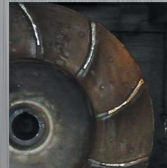
Posebno razvijene i patentirane bočne rotorske lopatice izrađene od materijala tvrdoča većih od 2500 HV izuzetno su otporne na eroziju i abraziju. Kod korištenja dugotrajnih Vorax udarnih greda, moraju se i bočne rotorske lopatice prilagoditi višemesečnom radu bez zastoja i izmjena.
