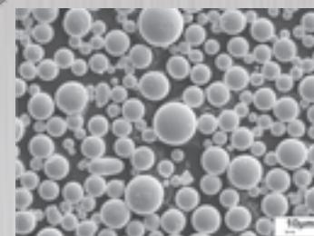
Unaprijeđenjem mikrostrukture postižu se vrhunske karakteristike. Zahvaljujući strogoj kontroli procesa proizvodnje, omogućene su uvijek jednako dobre karakteristike dodatnog materijala. Na slici je prikazan sferni volfram-karbidi koji ima 30% veću tvrdoću i oko 50% bolju otpornost na trošenje u odnosu na standardni volfram-karbidi.
