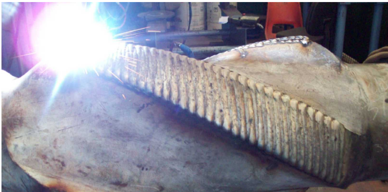
Slika 1. Prikaz automatiziranim postupkom navarene površine posebno razvijenim DURMAT NIFD žicama na bazi volfram karbida
